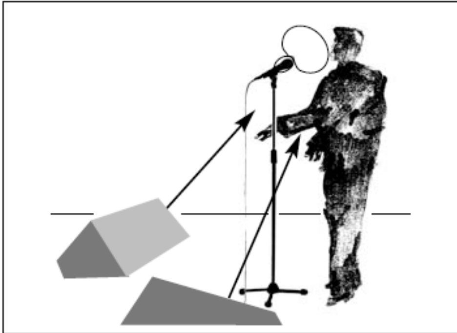
(A mikronos ideális elhelyezése, maximális gain-nél, még gerjedés nélkül.)
